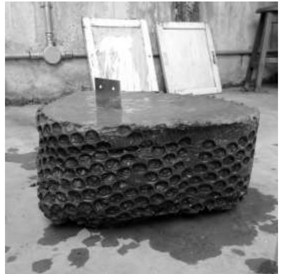
基礎用のコンクリートブロック
